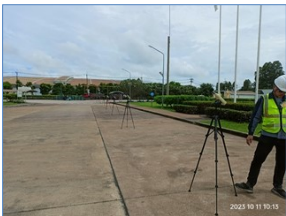
ภาพที่ 3.17.2 ภาพแสดงการตรวจวัดระดับเสียงในพื้นที่ทำงานเพื่อจัดทำ Noise contour map
