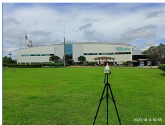
ภาพที่ 3.17.2 ภาพแสดงการตรวจวัดระดับเสียงในพื้นที่ทำงานเพื่อจัดทำ Noise contour map
